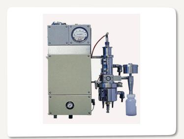
Поточный анализатор несгоревшего углерода для биомассы (UBC-2000) автоматически дает операторам постоянную поточную информацию о количестве несгоревшего углерода (UBC) в летучей золе дожигания биомассы, а также физические пробы для дальнейшего анализа.
